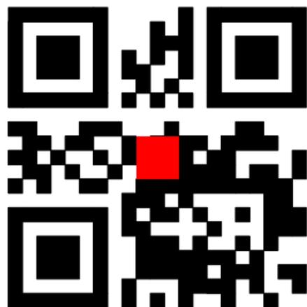
Trotz rotem Quadrat ist die korrekte Dekodierung möglich
