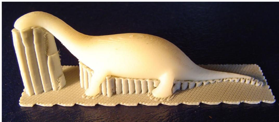
Figure: Dinosaurier mit FFF (FDM)-Verfahren
