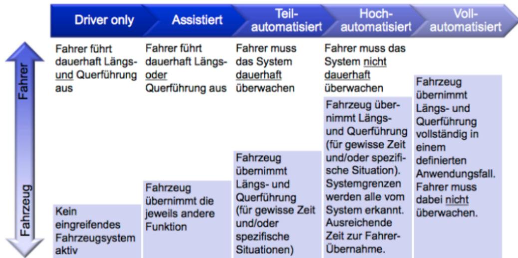
Figure: Übersicht der Fahrzeugtypen.
