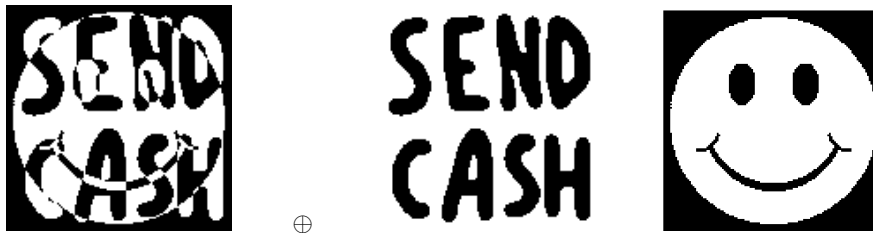
Figure 1.3: Werden nun die beiden Ciphertexte ge-XORed, ergibt sich ein XOR (Overlay) der beiden binären Plaintexte.
